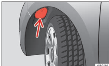
Fig. 91 Remplacement de l'ampoule des feux de croisement : ailes des roues.
