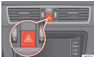
Fig. 132 Combiné d'instruments : commande des feux de détresse.
