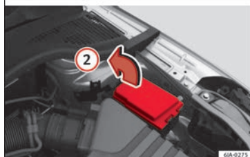
Fig. 87 Dans le compartiment moteur : cache du boîtier de fusibles - Variante 2
