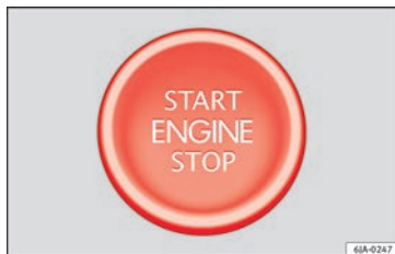
Fig. 172 Sur la colonne de direction : bouton de démarrage du système de fermeture et de démarrage sans clé Keyless Access. Sur les véhicules avec le volant à droite, le réglage est symétrique.
