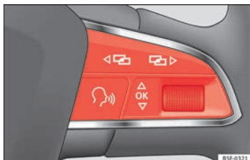
Fig. 36 Partie droite du volant multifonction : touches de contrôle.
