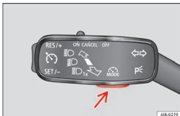
Fig. 190 Sur le levier des clignotants et des feux de route : touche des systèmes d'aide à la conduite.
