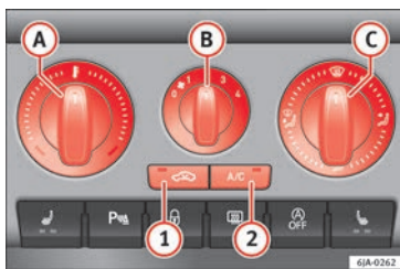
Fig. 46 Dans la console centrale : commandes du climatiseur manuel.
