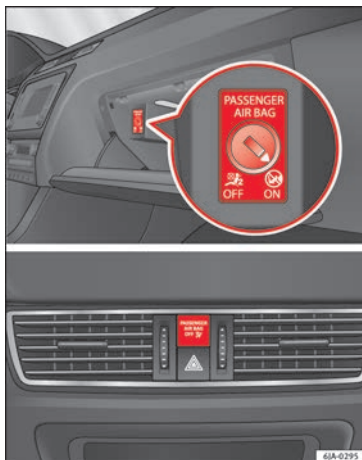
Fig. 81 Commande de l'airbag frontal du passager avant/témoin de désactivation de l'airbag passager
