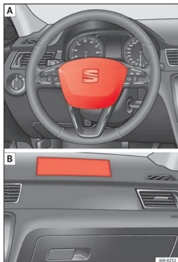
Fig. 15 Airbag conducteur sur le volant et airbag passager dans le tableau de bord.
