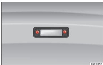
Fig. 106 Démontage de l'éclairage de la plaque d'immatriculation.
