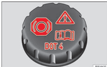
Fig. 52 Compartiment-moteur : bouchon du réservoir du liquide de frein.
