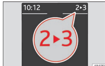
Fig. 38 Combiné d'instruments : indicateur du rapport le plus économique (boîte mécanique)
