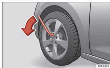
Fig. 62 Changement de roue : desserrer les vis de roue.
