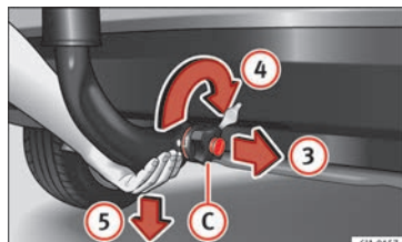
Fig. 201 Déverrouillez la barre à boule d'attelage.
