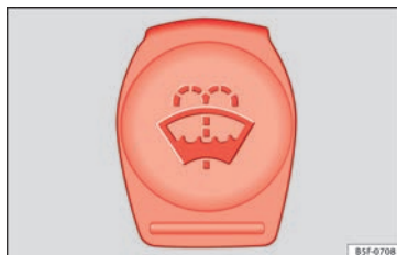
Fig. 53 Dans le compartiment moteur : bouchon du réservoir de liquide lave-glace.
