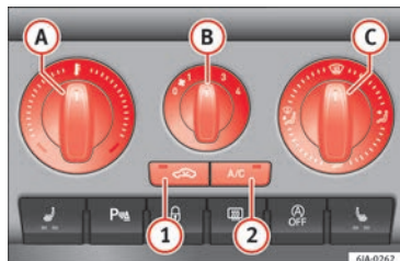
Fig. 169 Climatiseur : éléments de commande.
