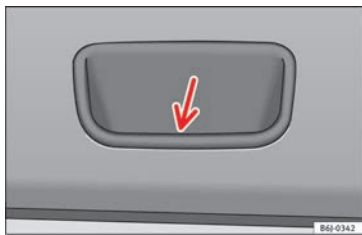
Fig. 126 Détail de la garniture intérieure du hayon : cavité pour tirer.
