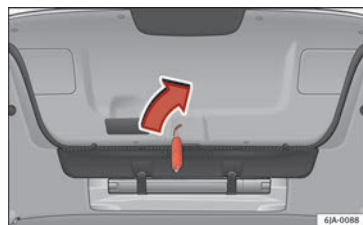
Fig. 6 Coffre à bagages, côté droit : accès au déverrouillage d'urgence.
