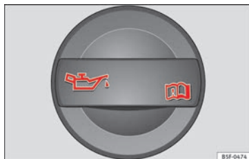
Fig. 50 Dans le compartiment-moteur : bouchon de l'orifice de remplissage d'huile moteur.
