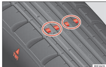
Fig. 175 Sculptures du pneu : indicateurs d'usure.
