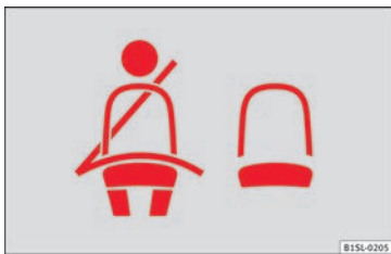
Fig. 68 Indication de l'état de la ceinture de la banquette arrière sur l'écran du tableau de bord.
