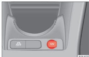
Fig. 133 Console centrale avant : prise de courant de 12 volts dans le vide-poches.
