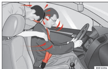
Fig. 71 L'occupant de la banquette arrière non attaché est projeté en avant et vient heurter le conducteur attaché.
