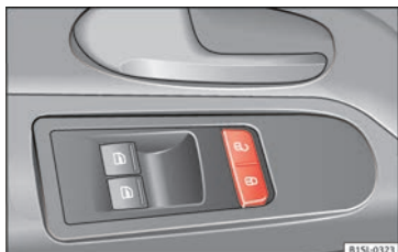
Fig. 2 Sur la porte du conducteur : touche de verrouillage centralisé.
