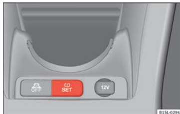
Fig. 176 Console centrale : touche du système de contrôle de la pression des pneus
