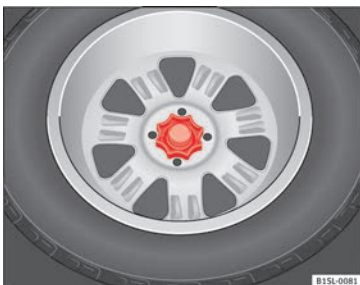
Fig. 177 Dans le coffre à bagages : roue à main pour la fixation de la roue de secours.
