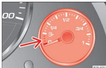
Fig. 164 Sur le tableau de bord : indicateur de niveau de carburant pour essence.
