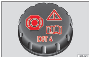
Fig. 43 Compartiment-moteur : bouchon du réservoir du liquide de frein.
