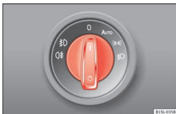
Fig. 109 Côté volant : représentation de certaines variantes de la commande des feux.
