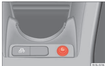
Fig. 132 Sur la console centrale avant : allume-cigare.
