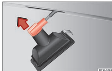
Fig. 91 Feu de plaque d'immatriculation : démonter le support d'ampoules.
