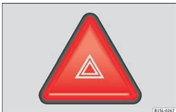
Fig. 110 Planche de bord : touche d'activation et de désactivation des feux de détresse.
