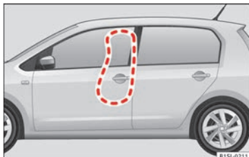
Fig. 22 Sur le côté gauche du véhicule : zone de déploiement de l'airbag latéral.
