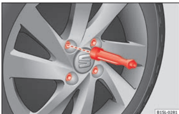
Fig. 57 Changement de roue : desserrer les boulons de la roue avec le manche du tournevis.
