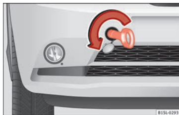
Fig. 58 Pare-chocs avant droit : œillet de remorquage vissé
