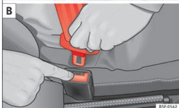
Fig. 14 Placer et retirer le pêne de verrouillage de la ceinture de sécurité.
