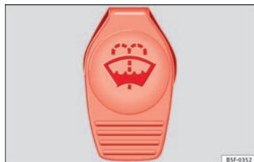
Fig. 44 Dans le compartiment moteur : bouchon du réservoir de liquide lave-glace.
