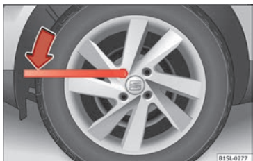
Fig. 53 Changement de roue : desserrez les boulons de la roue.
