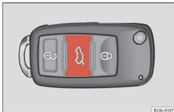
Fig. 106 Sur la clé du véhicule : bouton de déverrouillage et ouverture du hayon.
