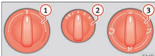
Fig. 139 Dans la console centrale : Commande rotative du système de chauffage et d'air frais.
