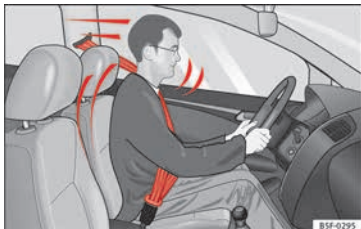
Fig. 69 Les conducteurs qui ont correctement bouclé leur ceinture de sécurité ne seront pas projetés en cas de freinage soudain.
