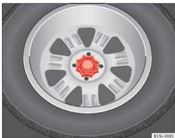
Fig. 176 Dans le coffre à bagages : roue à main pour la fixation de la roue de secours.
