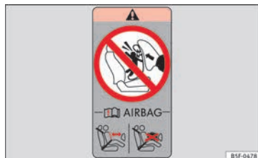
Fig. 24 Sur le cadre arrière de la porte du passager : autocollant concernant l'airbag.
