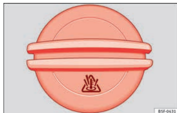
Fig. 42 Compartiment-moteur : bouchon du vase d'expansion du liquide de refroidissement.
