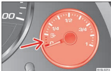
Fig. 163 Sur le tableau de bord : indicateur de niveau de carburant pour essence.
