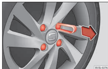
Fig. 52 Retirez les capuchons des boulons de la roue.
