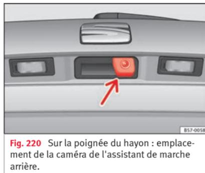
Fig. 220 Sur la poignée du hayon : emplacement de la caméra de l'assistant de marche arrière.
