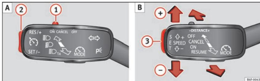
Fig. 52 À gauche de la colonne de direction : **A** commande et touches permettant d'utiliser le régulateur de vitesse ; **B** troisième levier permettant d'utiliser le régulateur de vitesse
