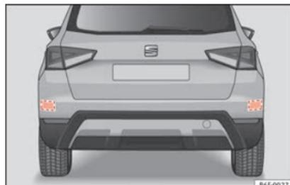
**Fig. 202** Vue arrière du véhicule : zones des capteurs radars.
