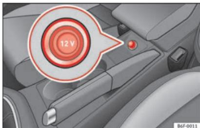
Fig. 162 Prise de courant avant.
