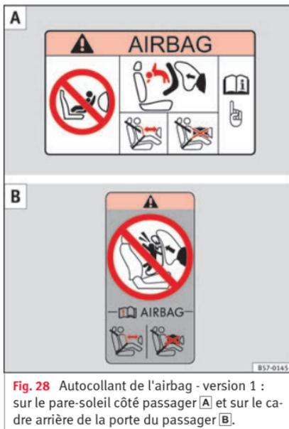
Fig. 28 Autocollant de l'airbag - version 1 : sur le pare-soleil côté passager **A** et sur le cadre arrière de la porte du passager **B**.
