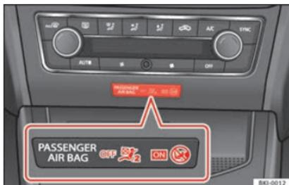
**Fig. 104** Sur le tableau de bord, au centre : témoin de désactivation de l'airbag du passager avant.
