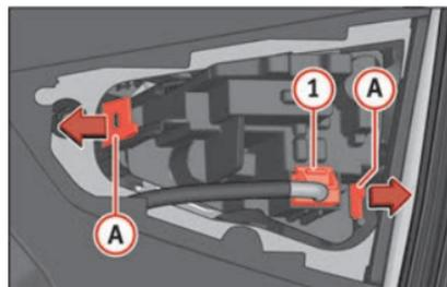
**Fig. 119** Démontez le porte-ampoule.
