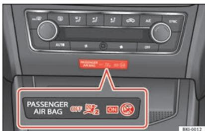
Fig. 23 Sur le tableau de bord, au centre : témoin de désactivation de l'airbag du passager avant.
