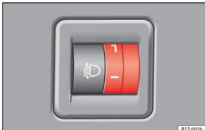
**Fig. 148** Planche de bord : dispositif de réglage de la portée des phares.
