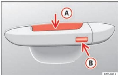
**Fig. 143** Système de fermeture et de démarrage sans clé Keyless Access : surface sensible (A) de déverrouillage vers l'intérieur de la poignée de porte, et surface sensible (B) de verrouillage vers l'extérieur de la poignée de porte.
