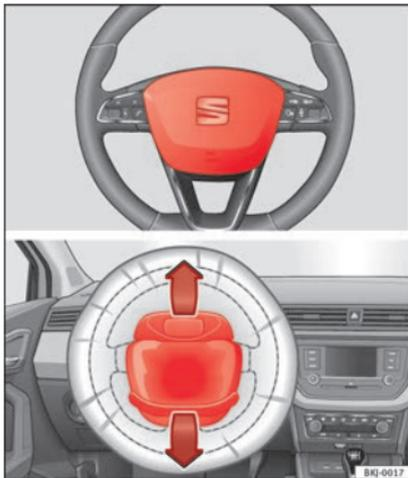
Fig. 20 Airbag du conducteur dans le volant.
