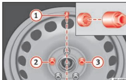
Fig. 82 Changement de roue : valve du pneu ① et emplacement de montage du boulon de roue antivol ② ou ③.
