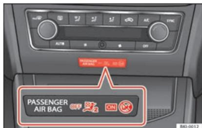
Fig. 56 Témoin de désactivation de l'airbag du passager.
