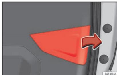
**Fig. 118** Hayon arrière ouvert : retirer le cache.
