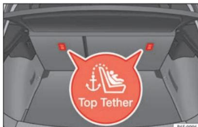
**Fig. 36** Position des anneaux Top Tether sur la partie arrière de la banquette arrière.
