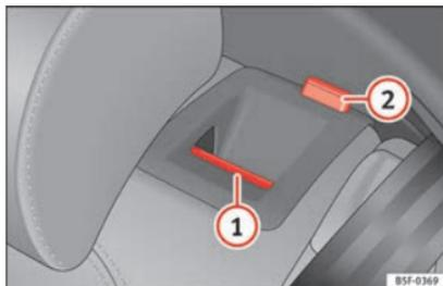
Fig. 156 Dans le dossier de la banquette arrière : touche de déverrouillage ① ; repère rouge ②
