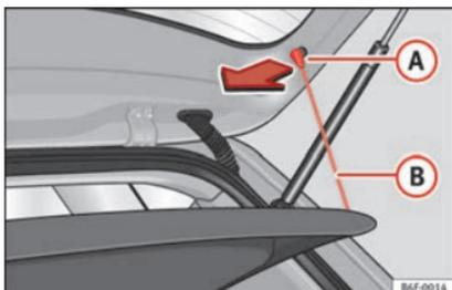
**Fig. 165** Dans le coffre à bagages : dépose et repose de la plage arrière.
