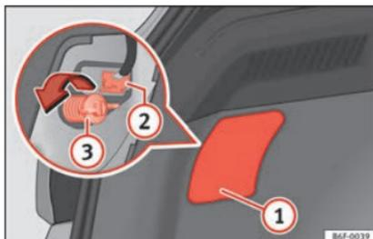
**Fig. 116** Coffre à bagages : accès à la vis de fixation du feu arrière.
