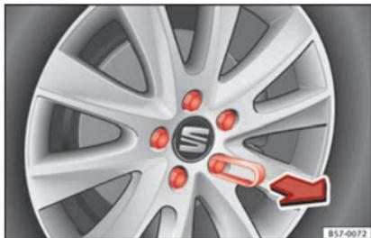
Fig. 80 Roue : boulons de roue avec capuchons.
