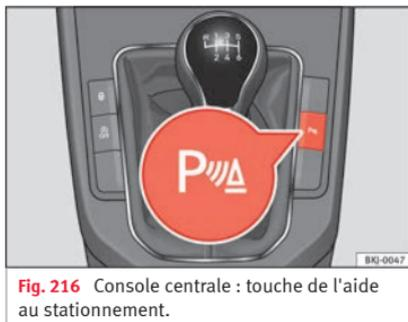
Fig. 216 Console centrale : touche de l'aide au stationnement.
