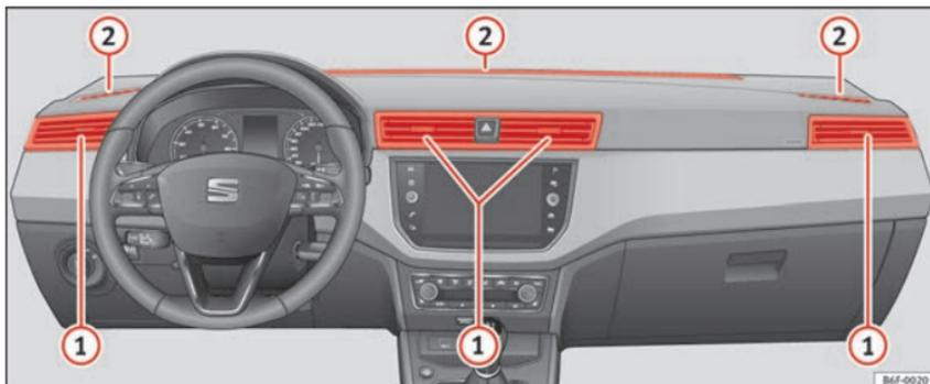
Pour garantir le chauffage, le refroidissement et la ventilation à l'intérieur de l'habitacle, les diffuseurs d'air » fig. 171 1 doivent rester ouverts.
