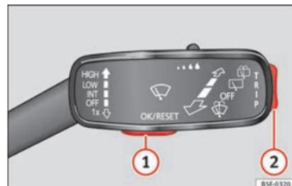
Fig. 46 Levier d'essuie-glace : touches de contrôle.
