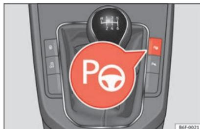
**Fig. 209** Dans la console centrale : touche permettant de connecter le système de stationnement assisté.
