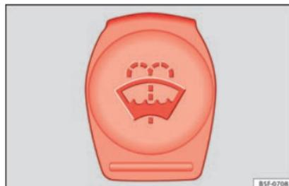
**Fig. 69** Dans le compartiment moteur : bouchon du réservoir de liquide lave-glace.
