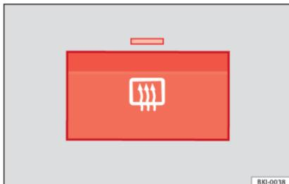
**Fig. 150** À côté des commandes de climatisation : contacteur de dégivrage de lunette arrière.
