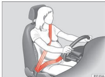
**Fig. 102** Ajustement recommandé de la sangle de ceinture de sécurité pour les femmes enceintes.
