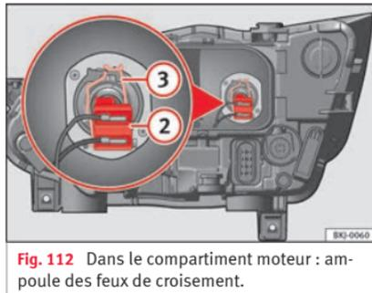
**Fig. 112** Dans le compartiment moteur : ampoule des feux de croisement.
