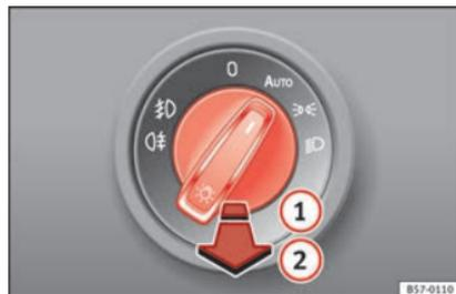
Fig. 146 Planche de bord : commande des feux.
