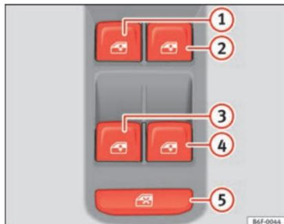
Fig. 11 Détail de la porte du conducteur : commandes des fenêtres.
