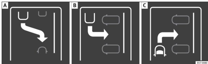
**Fig. 210** Vue d'ensemble des affichages réduits pour les modes de stationnement : **A** Stationnement en créneau en marche arrière. **B** Stationnement en bataille en marche arrière. **C** Stationnement en bataille en marche avant.
