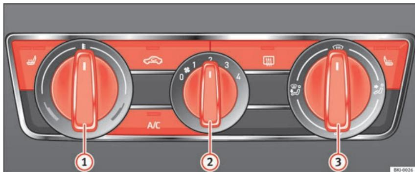
Fig. 173 Sur le tableau de bord : éléments de commande du climatiseur
