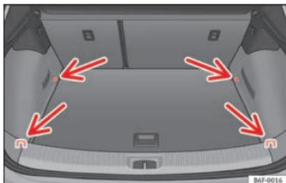
**Fig. 167** Emplacements des œillets d'arrimage dans le coffre à bagages.
