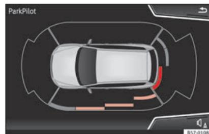
**Fig. 218** Affichage de l'aide au stationnement à l'écran du système Easy Connect.
