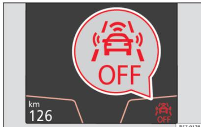
**Fig. 191** Sur l'écran du combiné d'instruments : indication de Front Assist désactivé.
