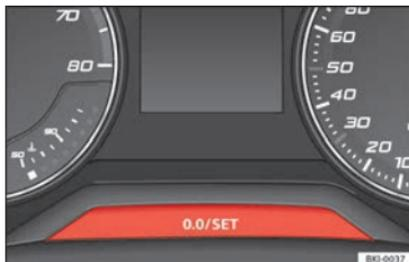
Fig. 126 Combiné d'instruments : compteur kilométrique et touche de remise à zéro.
