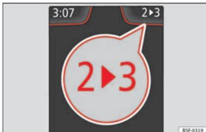
Fig. 49 Combiné d'instruments : indicateur du rapport le plus économique (boîte mécanique)
