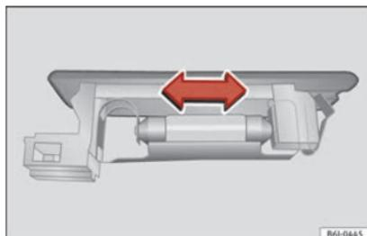
**Fig. 123** Éclairage du coffre à bagages.
