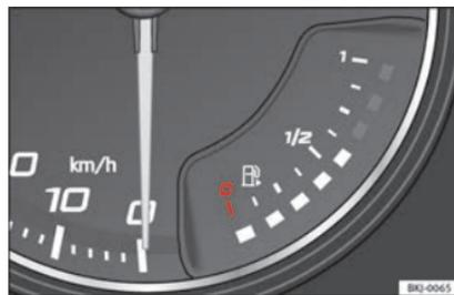
**Fig. 128** Indicateur de carburant.
