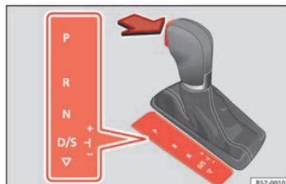
Fig. 58 Boîte automatique : positions du levier sélecteur.
