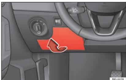
Fig. 70 Sur le tableau de bord côté conducteur : cache du boîtier de fusibles.
