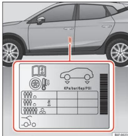
Fig. 239 Emplacement de l'adhésif de gonflage des pneus.
