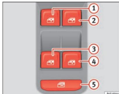
**Fig. 145** Détail de la porte du conducteur : commandes pour les glaces avant et arrière.
