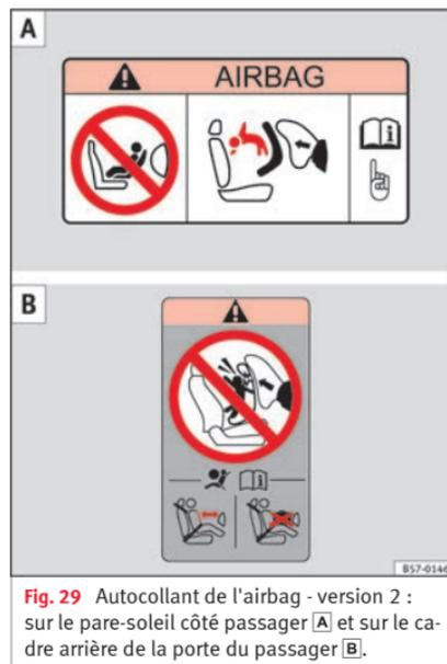
Fig. 29 Autocollant de l'airbag - version 2 : sur le pare-soleil côté passager **A** et sur le cadre arrière de la porte du passager **B**.
