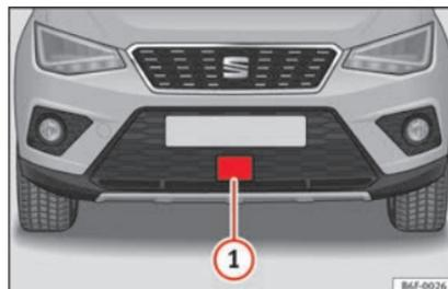
**Fig. 195** Au niveau du pare-chocs avant : capteur radar.
