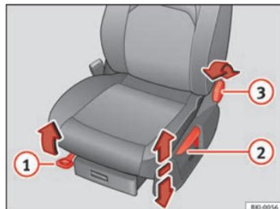
Fig. 13 Sièges avant : réglage manuel du siège.
