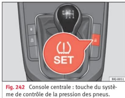
Fig. 242 Console centrale : touche du système de contrôle de la pression des pneus.
