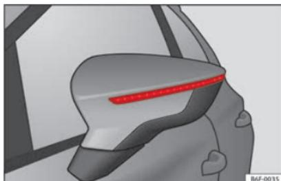
Fig. 120 Clignotant intégré au rétroviseur
