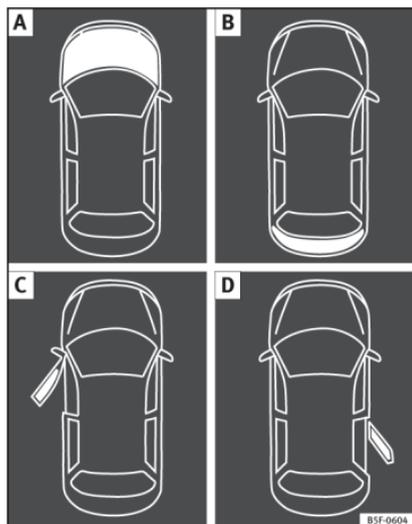
**Fig. 48** A : capot-moteur ouvert ; B : hayon ouvert ; C : porte avant gauche ouverte ; D : portière arrière droite ouverte (uniquement sur les véhicules 5 portes)
