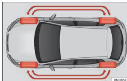
**Fig. 241** Schéma de permutation des roues.
