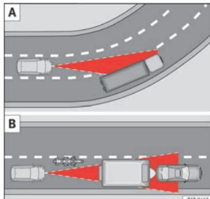
Fig. 199 (A) Véhicule à l'abord d'un virage. (B) Motocycliste circulant à l'avant hors du rayon d'action du capteur radar.
