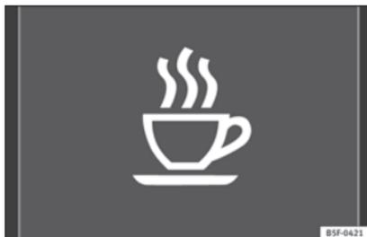
**Fig. 208** Sur l'écran du combiné d'instruments : symbole de détection de la fatigue.
