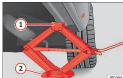
**Fig. 84** Mise en place du cric.
