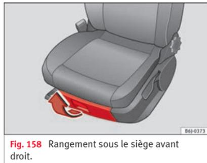
Fig. 158 Rangement sous le siège avant droit.
