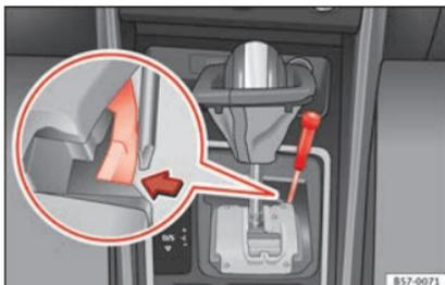
**Fig. 59** Levier sélecteur : déverrouillage d'urgence de la position de parking.
