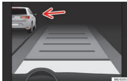
**Fig. 198** Sur l'écran du combiné d'instruments : ACC activé, véhicule circulant à gauche détecté
