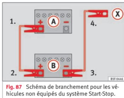
**Fig. 87** Schéma de branchement pour les véhicules non équipés du système Start-Stop.
