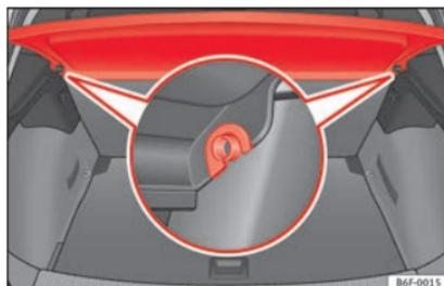
**Fig. 166** Dans le coffre à bagages : dépose et repose de la plage arrière.
