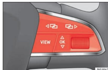
Fig. 47 Partie droite du volant multifonction : touches de contrôle.
