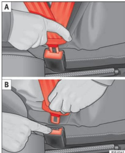
**Fig. 101** Placer et retirer le pêne de verrouillage de la ceinture de sécurité.
