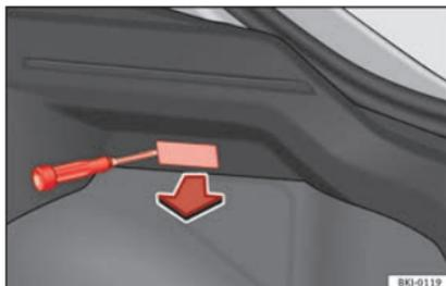
**Fig. 122** Éclairage du coffre à bagages.
