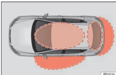
**Fig. 142** Système de fermeture et de démarrage sans clé Keyless Access : Zones de proximité.
