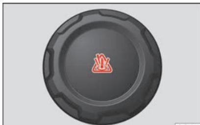
Fig. 67 Compartiment-moteur : bouchon du vase d'expansion du liquide de refroidissement.
