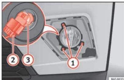
**Fig. 115** Phare antibrouillard : dépose du support d'ampoule
