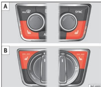
**Fig. 154** Dans la console centrale : commandes du chauffage des sièges avant. **A** : version avec Climatronic. **B** : version avec climatiseur manuel.
