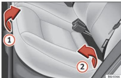
Fig. 155 Relever la banquette arrière.
