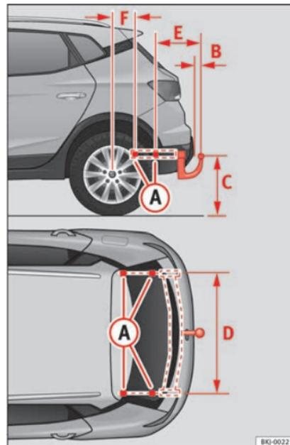
Fig. 235 Points de fixation du dispositif de remorquage.
