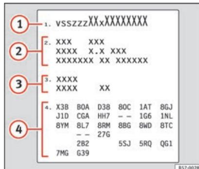
Fig. 244 Plaquette d'identification du véhicule (coffre à bagages).
