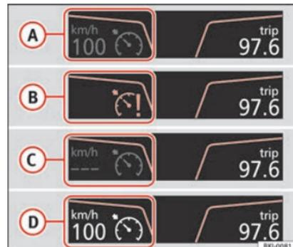
Fig. 185 Afficheur du combiné d'instruments indications d'état du GRA.
