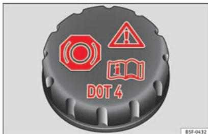
**Fig. 68** Compartiment-moteur : bouchon du réservoir du liquide de frein.
