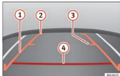
Fig. 221 Affichage sur l'écran du système d'infodivertissement lignes d'orientation.
