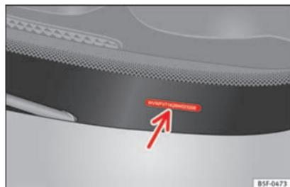
Fig. 245 Numéro de châssis.
