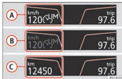
**Fig. 186** Sur l'écran du combiné d'instruments : indications de l'état du limiteur de vitesse.
