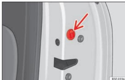
**Fig. 5** Verrouillage d'urgence de la porte.
