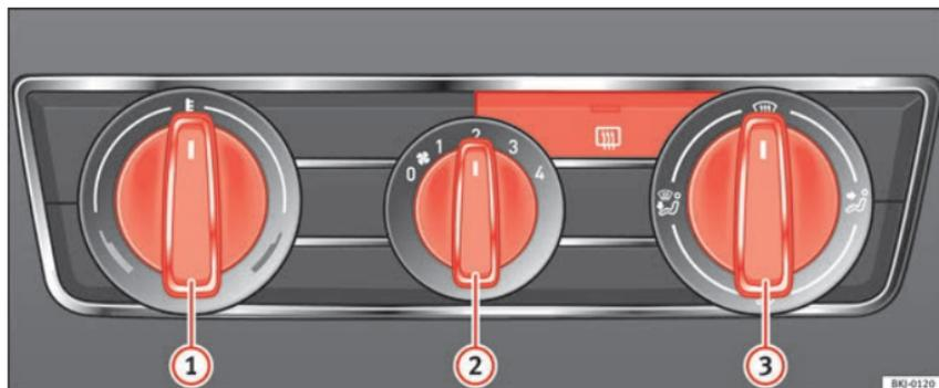
**Fig. 63** Dans la console centrale : commandes du système de chauffage et d'air frais.
