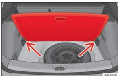
**Fig. 169** Plancher de coffre à bagages modulable : position inclinée.
