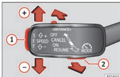
**Fig. 188** À gauche de la colonne de direction : troisième levier pour utiliser le limiteur de vitesse.
