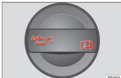
Fig. 66 Dans le compartiment-moteur : bouchon de l'orifice de remplissage d'huile moteur.
