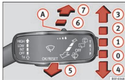
Fig. 43 Utilisation de l'essuie-glace avant et arrière.
