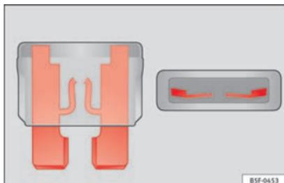
Fig. 72 Représentation d'un fusible grillé. »»
