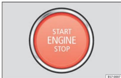
Fig. 176 Sur la partie inférieure de la console centrale : touche de démarrage.
