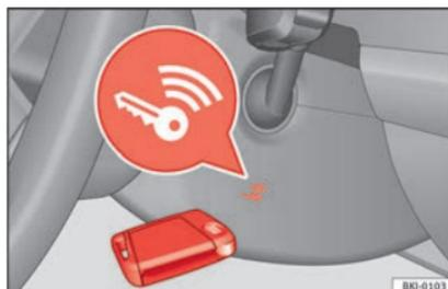
Fig. 177 À droite de la colonne de direction : démarrage d'urgence.
