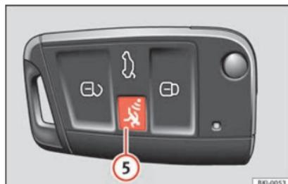
Fig. 136 Clé du véhicule avec bouton d'alarme.
