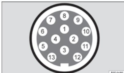
**Fig. 233** Représentation schématique : attribution des broches de la prise de courant de la remorque.
