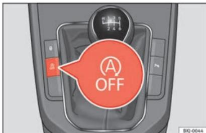
Fig. 184 Console centrale : touche du système Start-Stop.
