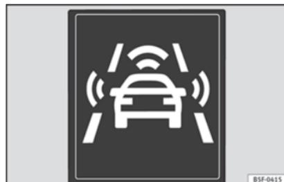
Fig. 189 Sur l'écran du combiné d'instruments : indications d'alerte préventive.
