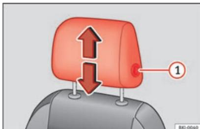
Fig. 14 Siège avant : réglage de l'appuie-tête.
