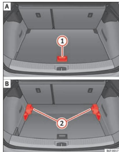
**Fig. 168** Plancher de coffre à bagages modulable : **A** position haute ; **B** position basse. »
