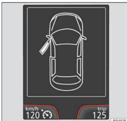
**Fig. 55** Sur l'écran du combiné d'instruments : indicateur de portes ouvertes.
