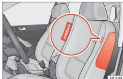
Fig. 24 Airbag latéral dans le siège du conducteur.
