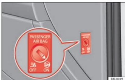
Fig. 22 Commande de l'airbag frontal du passager.
