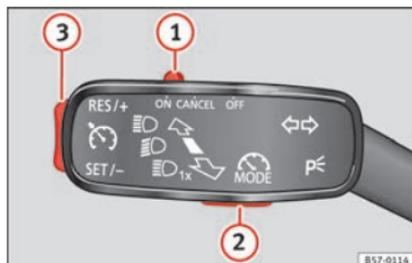
**Fig. 187** À gauche de la colonne de direction : commande et touches servant à utiliser le limiteur de vitesse.
