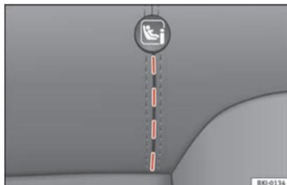
Fig. 34 Banquette arrière : rainures prédécoupées.
