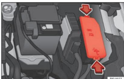
Fig. 71 Dans le compartiment moteur : cache du boîtier de fusibles.
