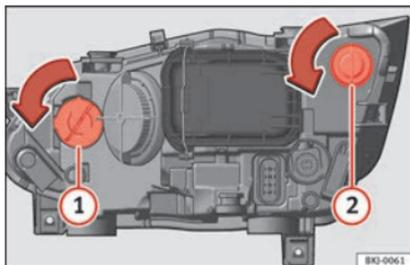
**Fig. 113** Dans le compartiment moteur : ampoule du clignotant **1** et ampoule du feu DRL (feu de circulation de jour) **2**.
