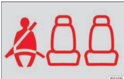
**Fig. 97** Combiné d'instruments : indication de place arrière droite occupée et de ceinture correspondante bouclée.
