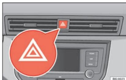
Fig. 41 Planche de bord : commande des feux de détresse.
