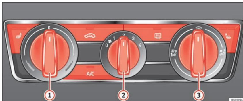
Fig. 62 Dans la console centrale : commandes du climatiseur manuel.
